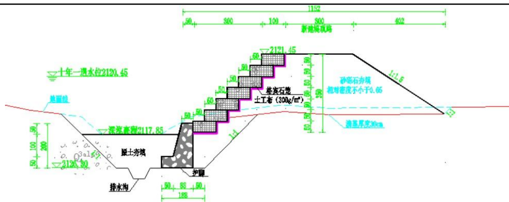
图 2-3 格宾挡墙防洪堤
